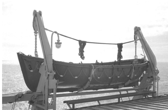
La lancia di salvataggio n° 3 armata con il vecchio sistema Fleming
