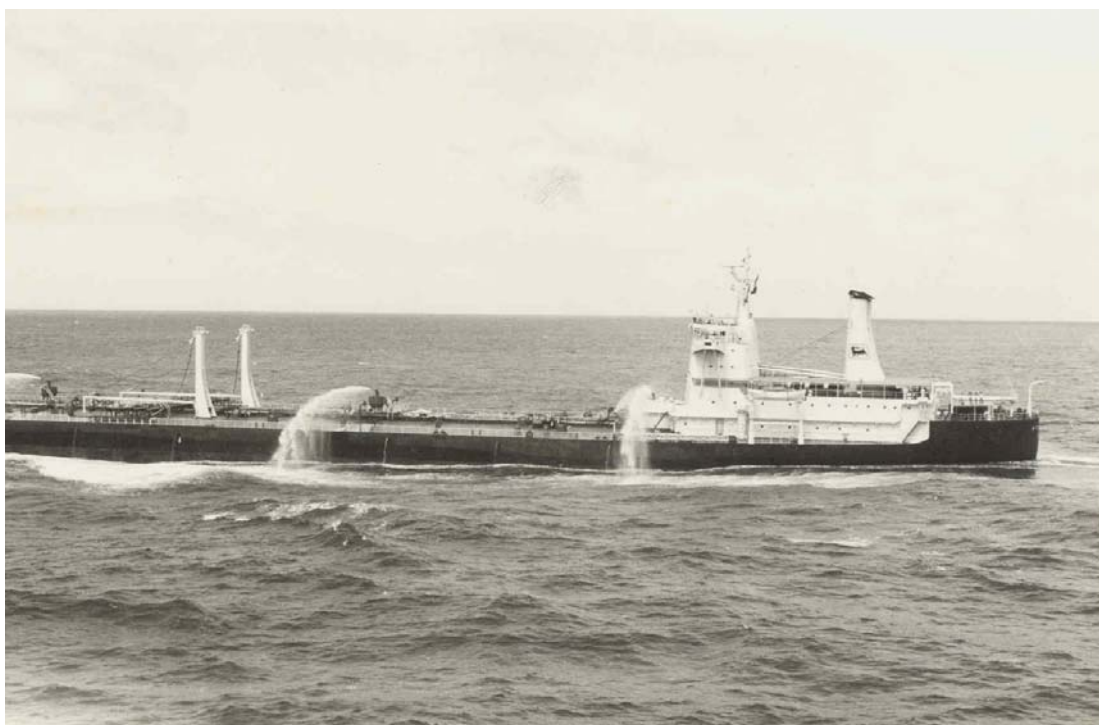
Prove dei cannoncini antincendio durante la navigazione
