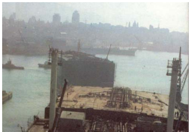
Allontanamento della prua per togliere la parte centrale dello scafo
