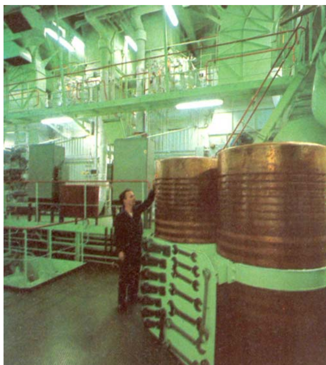
Sala macchina Particolare pistoni di rispetto
