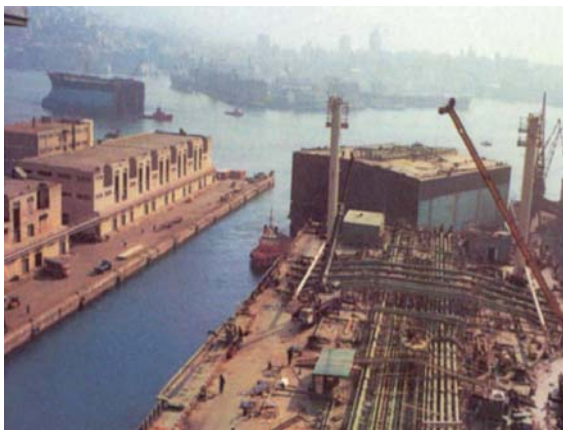
La parte centrale dello scafo viene tolto. In lontananza la prua della nave
