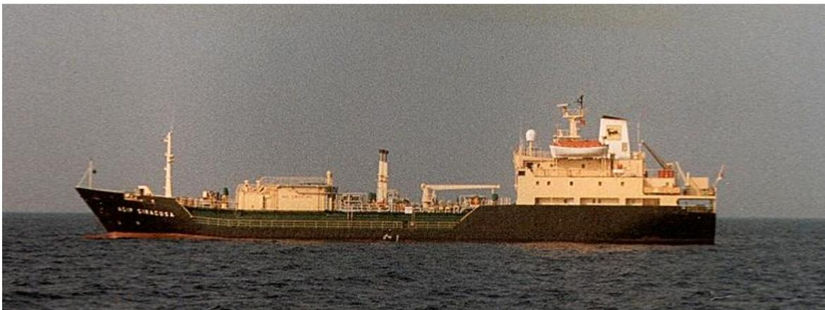
Etileniera, completamente refrigerata ed in grado di raggiungere temperature di  $-104^{\circ}\text{C}$ .
