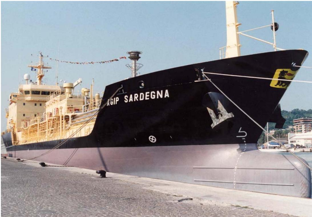
Gasiera semi-refrigerata, con impianto di riliquefazione con un sistema di contenimento in grado di sopportare una pressione fino a 7 kg/cmq ed una temperatura fino a -50°c.
