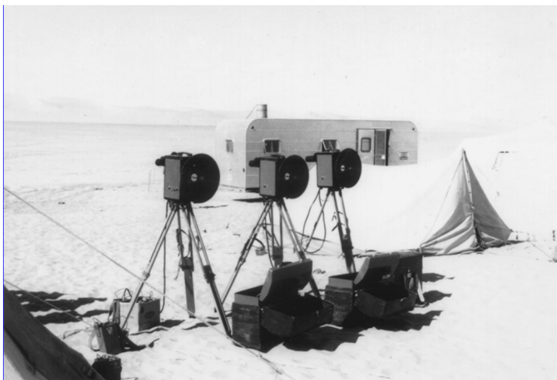
3. Tellurometri per la misura dei lati della poligonale di base per il rilievo topografico
