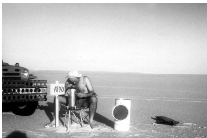
6 Stazione di misura di un gravimetro Worden e il campo espatriati della Fondazione Lerici
