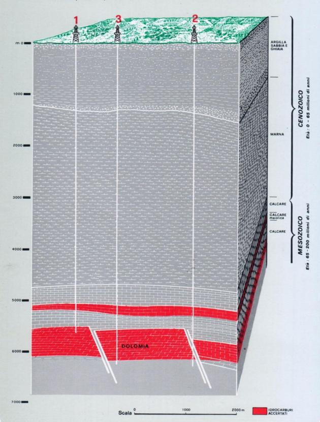
Il disegno rappresenta una ricostruzione schematica dimostrativa del sottosuolo in corrispondenza del giacimento di Malossa, basata sui dati dei tre pozzi finora eseguiti e sul rilievo geofisico.
