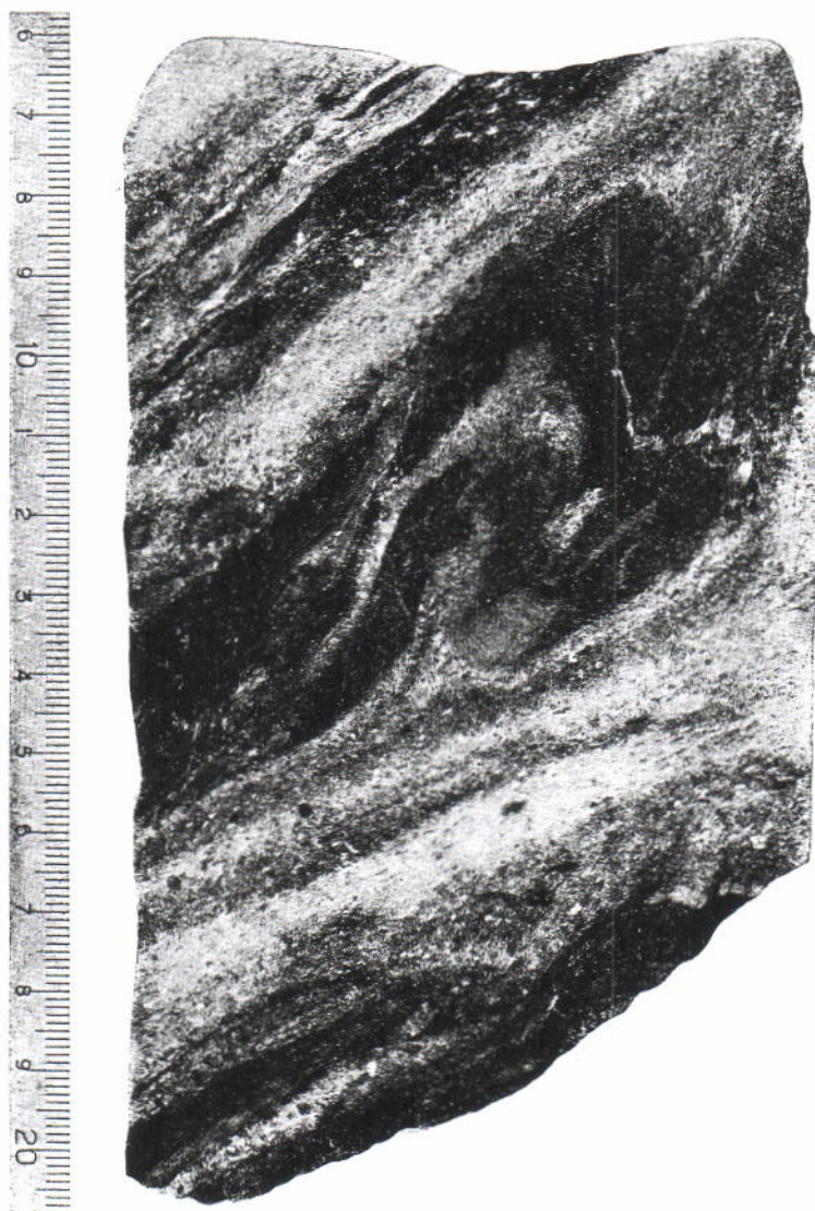
Fig. 9 - Pozzo Perugia 2, sezione della carota di 1200-1204 m: anidrite biancastra cristallina con intercalazioni di argilloscisti verdastri.
