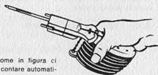
Applicato come in figura ci permette di contare automaticamente il numero delle pompate.
