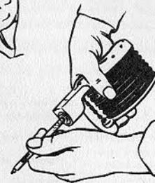
Fig. 2 Montaggio fialetta
