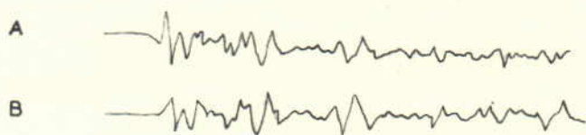
Fig. 12 Comparazione fra una registrazione a riflessione ottenuta a mezzo di apparecchiatura a tubo di ottone e una traccia sintetica ottenuta con il metodo fotoelettrico.
