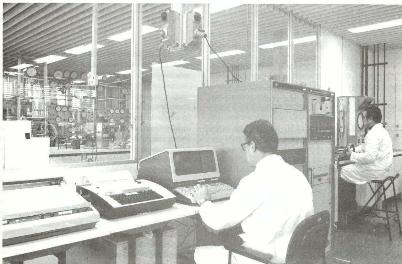
Fig. 14 – Calcolatore per il rilevamento dati, automazione e processing di risultati di esperienze su carote. Laboratori AGIP SpA.
