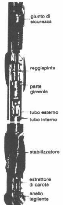
Carotiere Christensen a diamanti per il prelievo di carote in formazioni dure.
