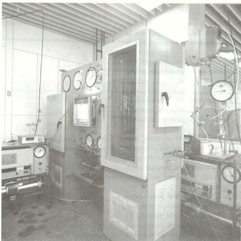
Fig. 13 – Apparecchiatura AGIP SpA per lo studio della compatibilità fra acqua d'iniezione, acqua di strato e roccia-serbatoio.
