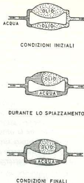
Fig. 4 — Avanzamento dell'acqua in una doppietta di pori (da Ref. 12).
