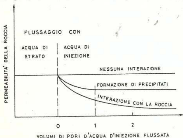
Fig. 15 - Risultati di prove di compatibilità fra acqua d'iniezione, acqua di strato e roccia-serbatoio.
