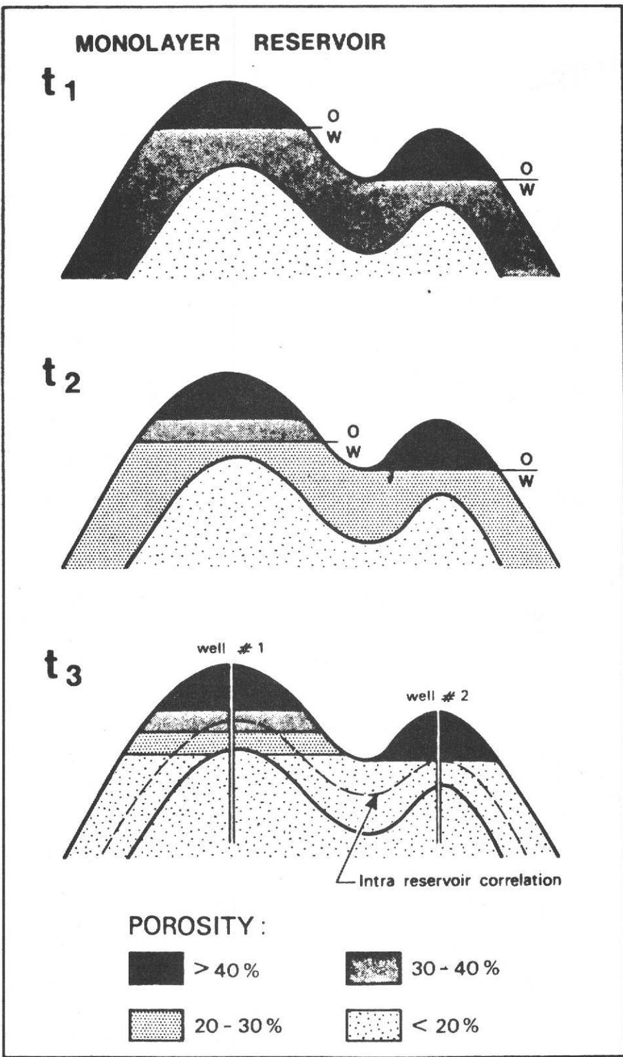
Fig. 45 - Evoluzione della migrazione degli idrocarburi e relativa distribuzione della porosità (da M. D'HEUR, 1984)
