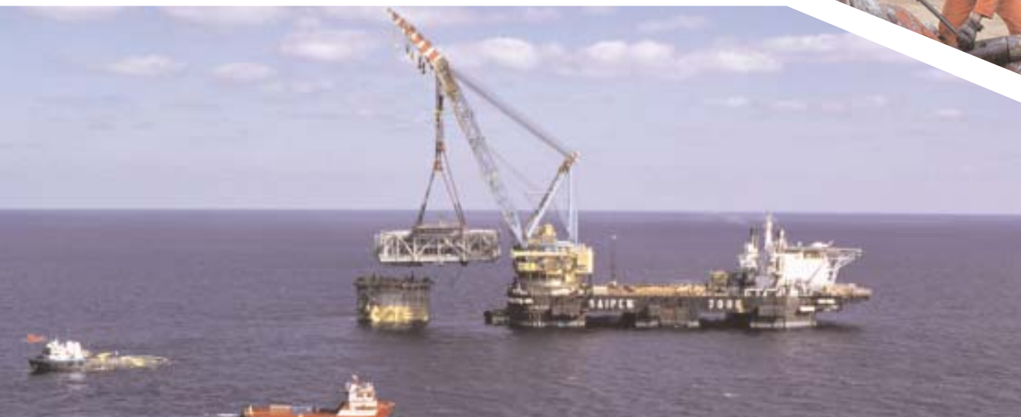
Saipem 7000, installazione modulo inferiore in posizionamento dinamico, Progetto Hoover-Diana, Golfo del Messico, USA, 1999
