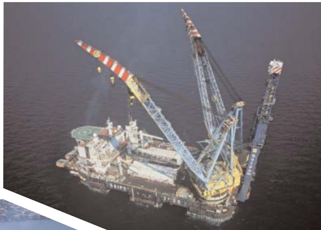
Saipem 7000, posa gasdotto da 24" Blue Stream, Mar Nero, Turchia, 2001
